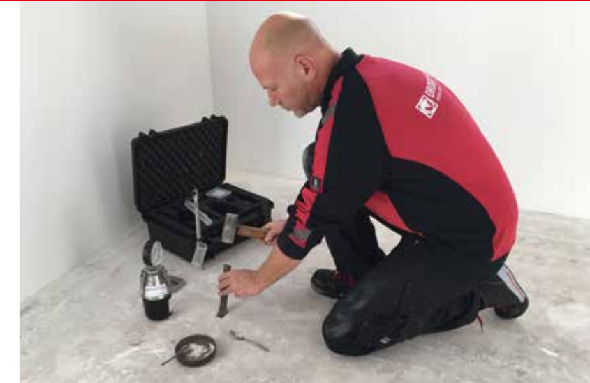
Carbidvochtmeting om vochtgehalte in dekvloer nauwkeurig te bepalen.
