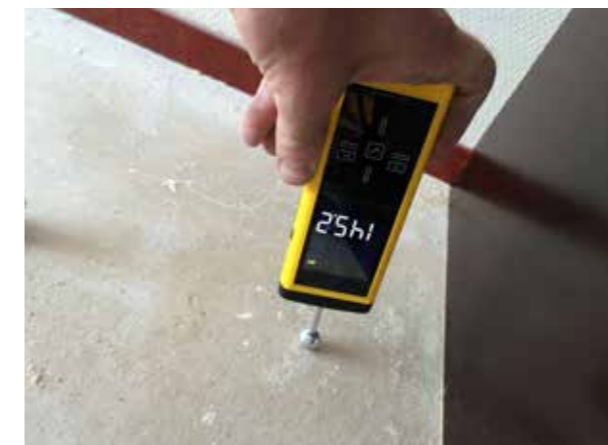
Met vochtmetingen controleren wij het droogproces.
