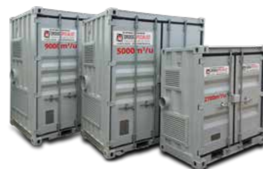
Munters MXT9000 Sorptiedroger Capaciteit: 1521 ltr / 24 uur Stroomverbruik: 115 Amp / 400 Volt
